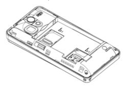
注意: 卡槽在电池底端,释放卡扣,放入 SIM 卡,扣上卡扣。
